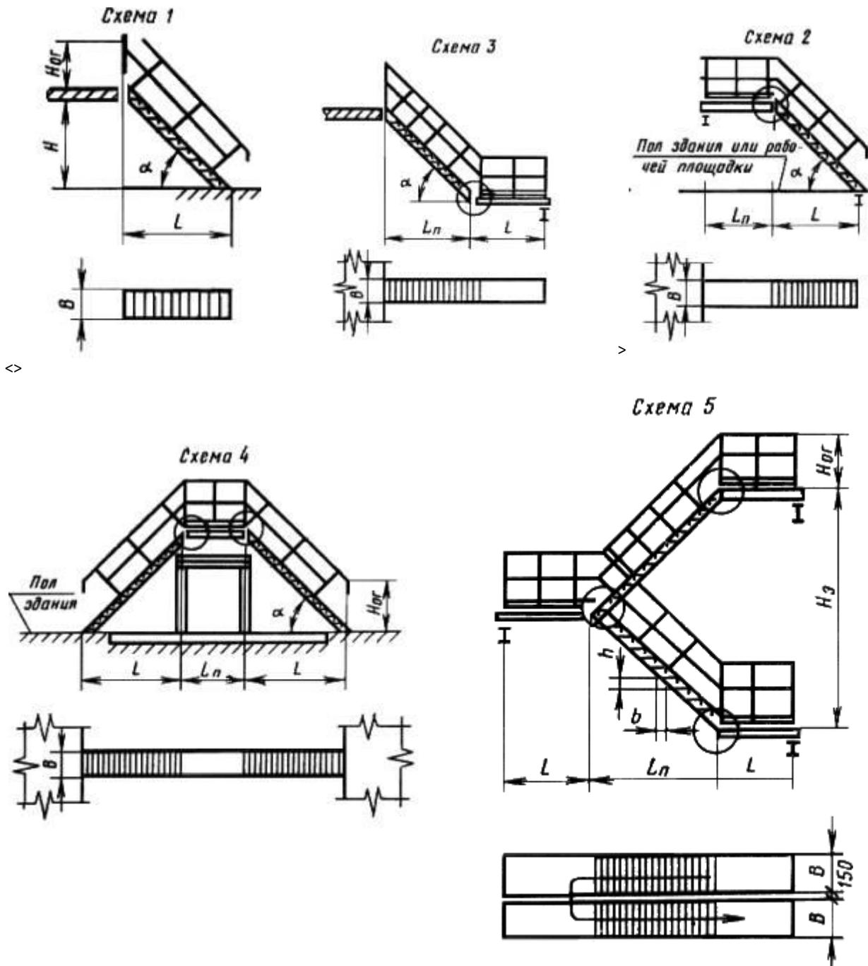
$H_3$  - высота этажа или расстояние между перекрытиями;  $H$ ,  $L$ ,  $B$ ,  $L_n$ ,  $H_{or}$  - номинальные размеры элементов лестниц;  $\alpha$  - угол наклона лестниц;  $b$  - ширина ступени;  $h$  - высота ступени
